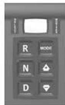
**VEHICLE DISPLAY CONTROLLER (VDC) (IF SO EQUIPPED)**
