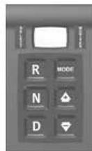
**VEHICLE DISPLAY CONTROLLER (VDC) (IF SO EQUIPPED)**
